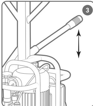
Работая рукояткой подъемника, создавайте давление, при этом платформа будет подниматься. Для опускания платформы сбросьте давление, переведя винт сброса давления в положение «OFF».
