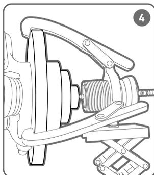
Установите захваты (лапы) съемника на демонтируемой детали и отрегулируйте расстояние между штоком и демонтируемой деталью так, чтобы шток уперся в вал.
