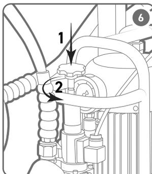
По окончании демонтажа детали, сбросьте давление в системе, для этого нажмите и поверните против часовой стрелки клапан сброса давления на гидравлической помпе.
