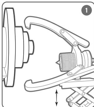
Подведите гидравлический съемник к демонтируемой детали. Установите съемник на необходимую высоту, используя гидравлический подъемник.
