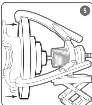
Приведите в работу гидравлический насос съемника, нажав кнопку «UP» на пульте управления. В процессе подачи гидравлического масла под давлением, захваты будут стягивать демонтируемую деталь.
