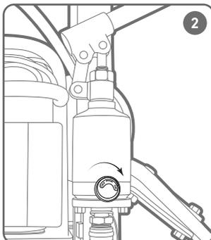
На гидроцилиндре подъемника поверните винт сброса давления в положение «ON», не создавая при этом чрезмерных усилий.
